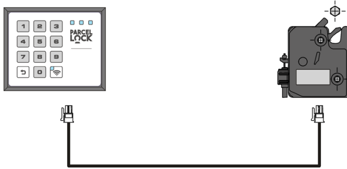
Einbauvariante „Standard“ mit einem Schloss am Beispiel SouthCo
